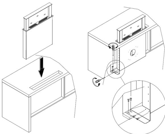
Nella cappa da piano è possibile collegare sulla parte frontale o posteriore un tubo diametro 150. Staccare con l'aiuto di un martello il tappo pre tranciato e fissare la flangia in dotazione con 4 viti. Successivamente collegare il tubo. Lateralmente e sotto invece è possibile il collegamento di un tubo 220x90 o 230x80 su ambo i lati (Fig. 1A).
