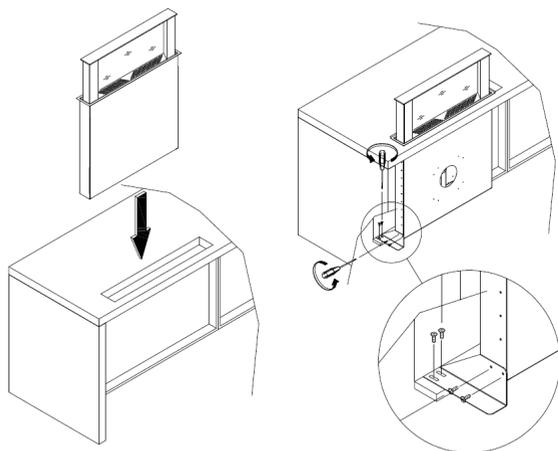
En la campana de encimera se puede conectar en la parte frontal o posterior un tubo de 150. Usando un martillo, desconectar el tapón pre-cortado y fijar la brida en dotación utilizando 4 tornillos. A continuación conectar el tubo.
