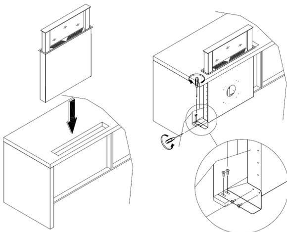
An die Tischhaube kann auf der Vorder- oder Rückseite ein Rohr mit einem Durchmesser von 150 angeschlossen werden. Lösen Sie mit einem Hammer dazu den ausgestanzten Verschluss und befestigen Sie den beiliegenden Flansch mit 4 Schrauben. Schließen Sie dann das Rohr an.
