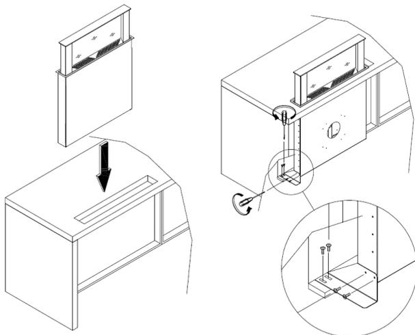
Ke stolní digestoři lze na přední nebo zadní straně namontovat trubku o průměru 150.
