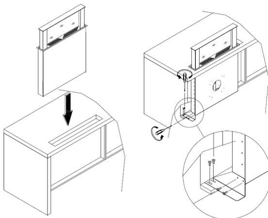
Op de voorzijde of achterzijde van de downdraft afzuigkap kan een buis met een diameter van 150. Verwijder met behulp van een hamer de voorgesneden dop en bevestig de meegeleverde flens met 4 schroeven. Verbind vervolgens de buis.
