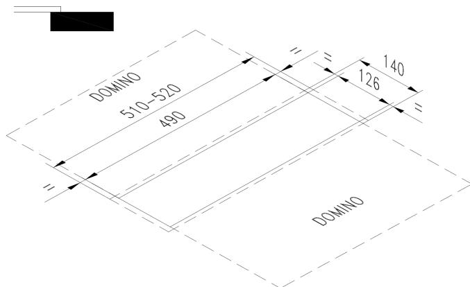
Zapuštěná montáž vestavěných v jednotkách:
