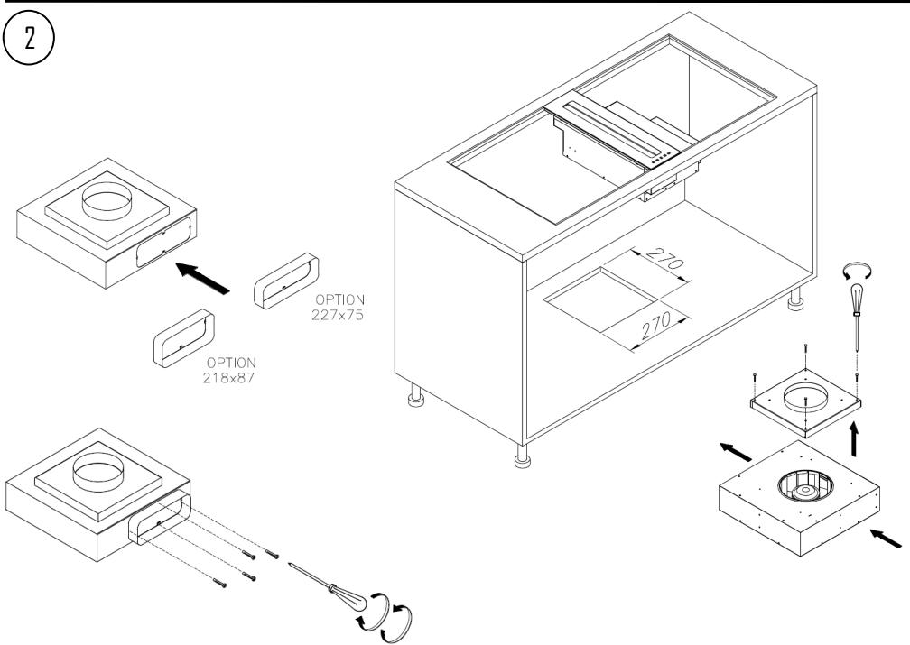
**3** ACHTUNG: Alle Verbindungsstücke der Kanäle müssen mit einem luftdichten Band (WIRD NICHT MIT-GELIEFERT) versiegelt werden
