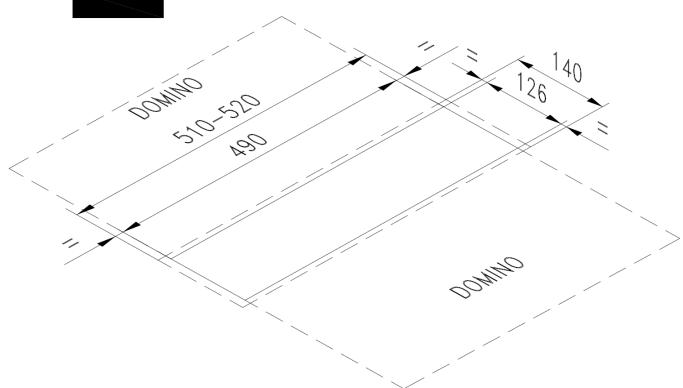
Flächenbündige Montage der Einbaugeräte:
