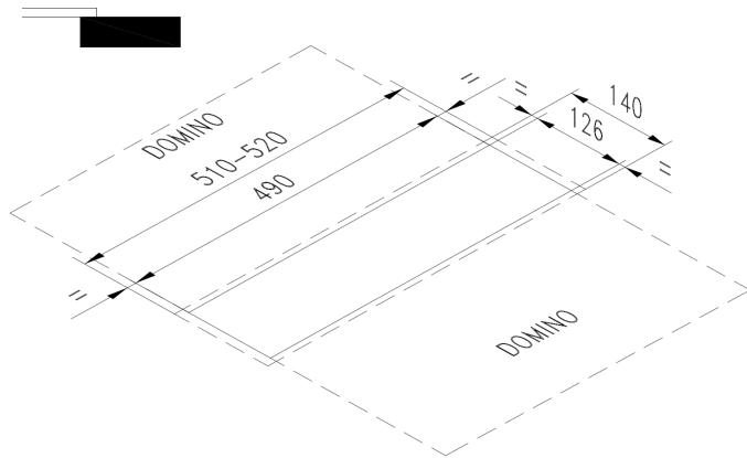
Vlakke montage van de inbouwapparatuur:
