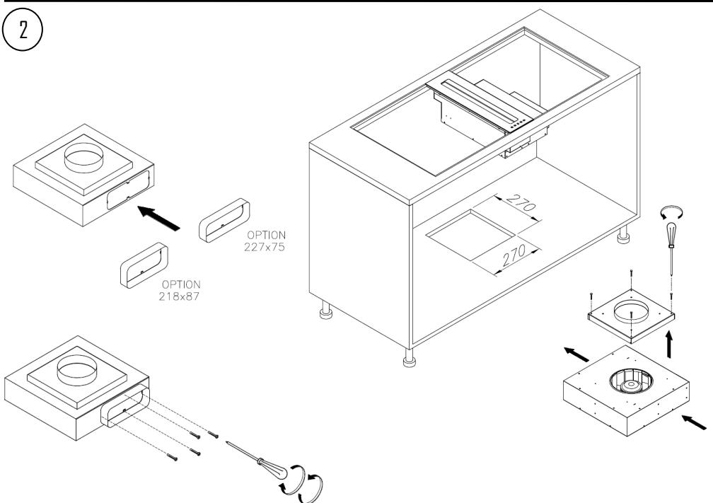
**3** ATENCIÓN: todos los acoplos de los canales deben estar sellados con cinta hermética al aire (NO EN DOTACIÓN)
